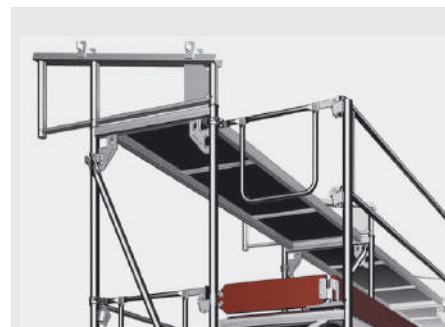
Poręcze ochronne na ostatnim poziomie, bezpieczny montaż dzięki tymczasowemu pomostowi na konsolach.
