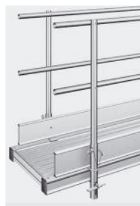
Montaż przy użyciu słupka do mocowania poręczy, rur i złączy rusztowaniowych
