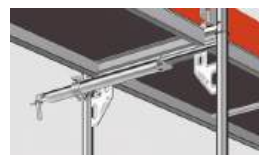
Zaczep kotwiący Blitz ze złączem krzyżowym.
