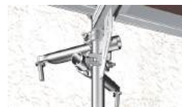
2 zaczepy kotwiące zamontowane w kształcie litery V z jednym złączem na każdy zaczep do wewnętrznego słupa
