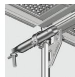
Zaczepek kotwiący, 0.38 m, montowany na jednym złączu krzyżowym do rury pionowej.
