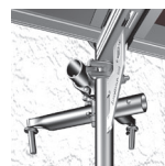
Dwa zaczepek kotwiące, 0.38 m, ułożone w literę V montowane na złączach krzyżowych do stojaka wewnętrznego.
