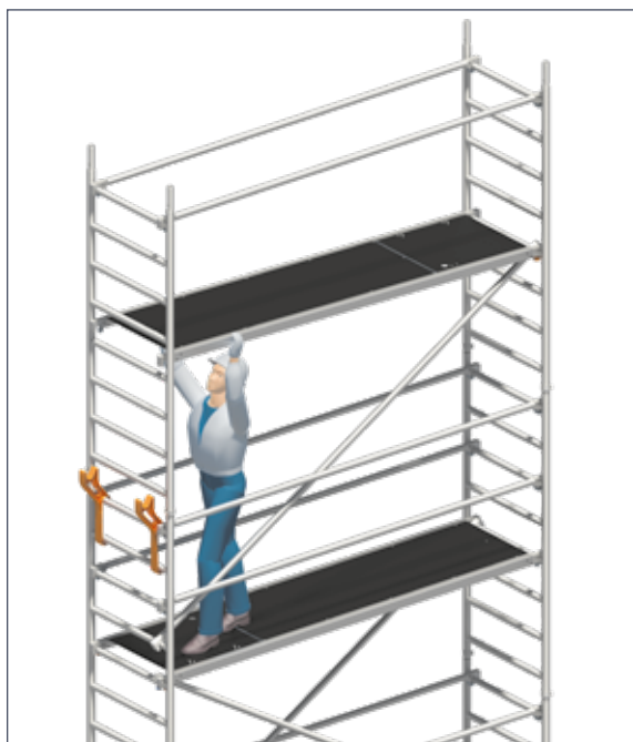
3 Zamontuj stężenia i pomost z włazem.
