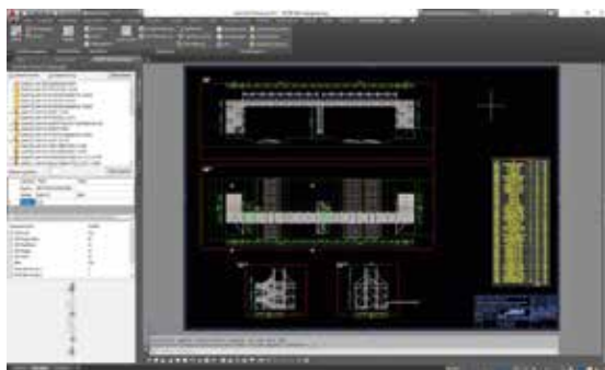
Tworzenie dokumentacji wraz z listą materiałową w LayPLAN CAD
