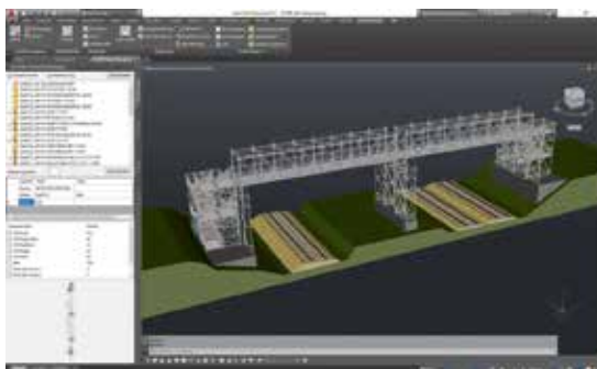
Planowanie zindywidualizowanych konstrukcji rusztowań w programie LayPLAN CAD
