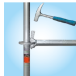
Jedno uderzenie młotkiem w klin zamienia połączenie kształtowe w trwałe połączenie siłowe (konstrukcyjne). Użyj młotka 500g.
